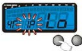
Appuyer sur le bouton Ajust pour sélectionner le nombre de pistons.
