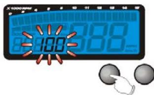
Appuyer sur le Bouton Adjust pour choisir le réglage EX : Maintenant la résistance est de 100 Ohms.
