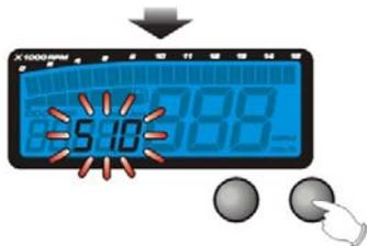
Appuyer sur le bouton Select pour retourner vers l'écran principal EX : Maintenant la résistance change de 100 Ohms vers 510 Ohms.
