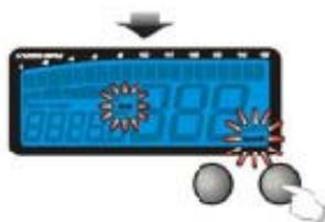
Appuyer sur le bouton Select 7Fois pour entrer dans les réglages Cycles / pistons / signal d'entrée.
