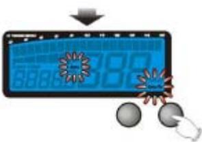
Appuyer sur le bouton Select pour entrer le diamètre de la roue
