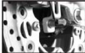
Installer le capteur sur la fixation.
