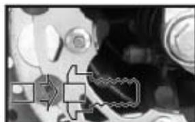
Insérer les aimants dans les vis du disque.
