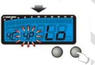
Appuyer sur le bouton Select pour sélectionner les pistons.
