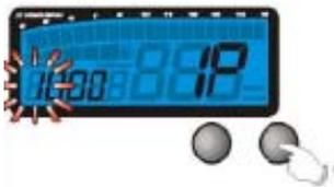
EX : le diamètre de la roue est de 1300mm, Appuyer sur le bouton Select pour faire basculer le curseur sur le chiffre désiré, EX : Maintenant le diamètre de roue est de 1000mm (le 1 clignote)
