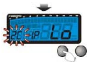
Appuyer sur le bouton Adjust pour sélectionner le temps du moteur (2 ou 4).
