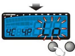
Appuyer le bouton Adjust pour choisir le type de signal d'entrée
